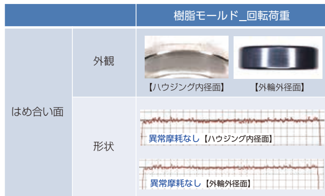
(a) 回転荷重条件における評価条件及び評価結果 (a) Test conditions and test results under rotating load
