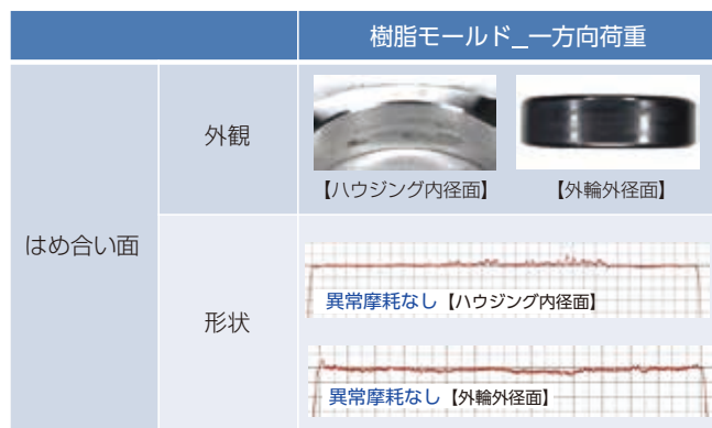
(b) 一方向荷重条件における評価条件及び評価結果 (b) Test conditions and test results under static load
