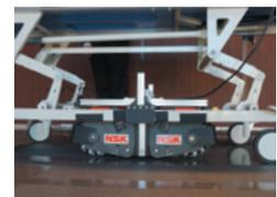
ストレッチャーの足元に搬送アシストロボットを搭載
