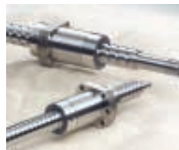
高防塵ボールねじ V1シリーズ NSKの技術を極めた高防塵シールを搭載、異物環境下で優れた能力を発揮し、長寿命を実現
