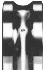
図 5.1 軌道面のフレーキング
