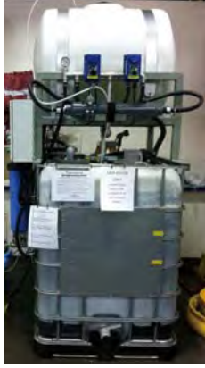
写真2 ベニントン工場に導入した床洗浄廃液の再生装置
