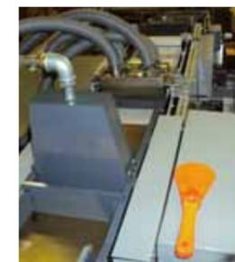
写真2 油回収装置
