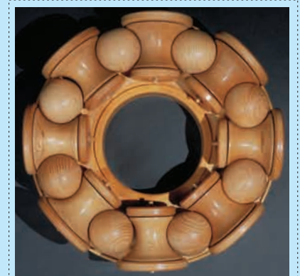
[デッサン図に基づき、近年作製されたベアリングの模型] [写真提供：フィレンツェ科学史博物館 (Istituto e Museo di Storia della Scienza)]
