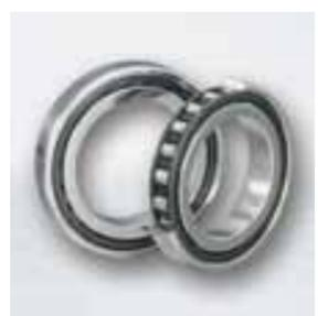
高耐熱性PEEK保持器の採用と耐熱・耐摩耗性に優れたSHX材でd<sub>mn</sub> 220万を実現しました。
