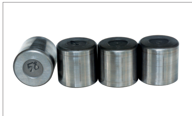
写真17-3 ●円筒ころ軸受のころ。 ●転動面に発生した軸方向のきず。 ●取付け時の内輪・外輪の傾きによるもの。
