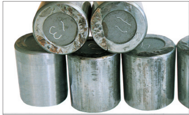
写真10-7 ●写真10-6の円すいころ。 ●ころ頭部端面に生じた段付き摩耗。 ●静止中の過大荷重下でフレッチングが進展したもの。
