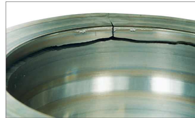
写真6-3 ●複列円筒ころ軸受の外輪。 ●軌道面に生じたフレーキングを起点にした軸方向と円周方向の割れ。 ●衝撃きずによるフレーキングからの発展。
