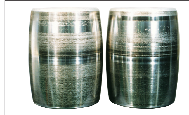
写真4-7 ●写真4-5の球面ころ。 ●転動面の中央に生じたスミアリング。 ●潤滑不良によるもの。
