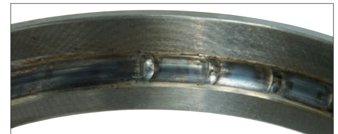
写真13-4 ●写真13-3の外輪。 ●軌道面が変色し、玉ピッチ間隔の溶融こんが生じている。 ●予圧過大によるもの。
