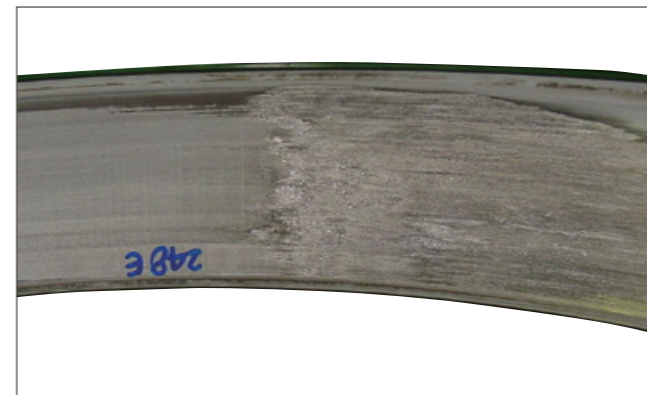
写真4-9 ●大形円すいころ軸受の外輪。 ●外輪軌道面に生じたスミアリング。 ●高速、軽荷重、潤滑不良によるもの。
