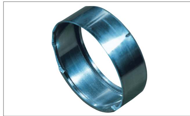
写真5-4 ●ソリッド形針状ころ軸受の外輪。 ●外輪つば部に生じた欠け。 ●過大荷重によるころの傾きが原因。
