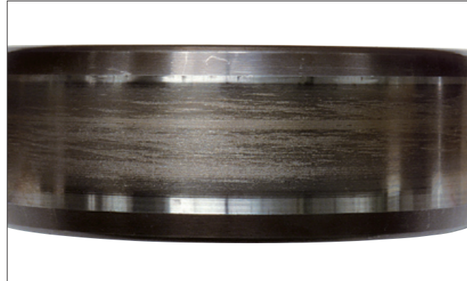
写真4-1 ●円筒ころ軸受の内輪。 ●軌道面の円周方向に生じたスミアリング。 ●潤滑グリースの封入過多によるころの滑りが原因。
