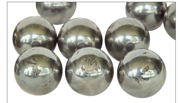
写真1-4 ●写真1-4のボール。 ●ボール表面のフレーキング。 ●運転休止時の衝撃荷重による圧こんからの進展。
