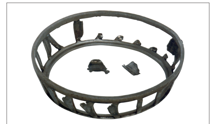
写真7-4 ●円すいころ軸受の保持器。 ●鋼板打抜き保持器の柱の折損。
