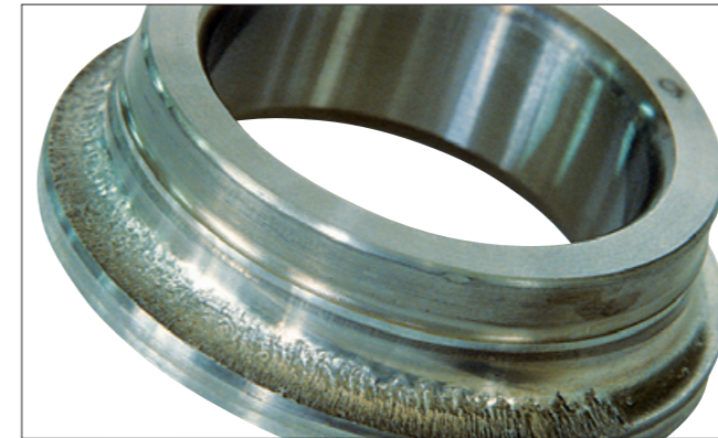
写真1-1 ●アンギュラ玉軸受の内輪。 ●軌道面の半周にわたり生じたフレーキング。 ●切削液の浸入による潤滑不良が原因。
