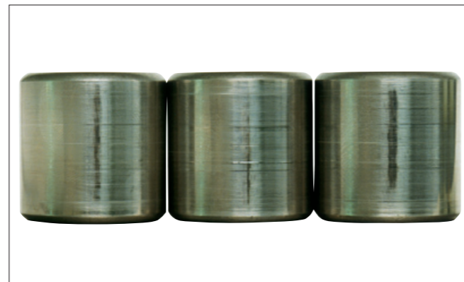
写真12-4 ●円筒ころ軸受のころ。 ●転動面に生じたフォールスブリネリング。 ●回転停止時の外部からの振動によるもの。
