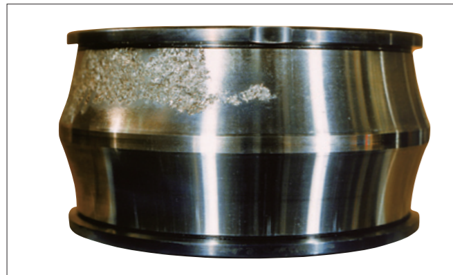
写真1-7 ●自動調心ころ軸受の内輪。 ●軌道面の片列のみに生じたフレーキング。 ●潤滑不良によるもの。
