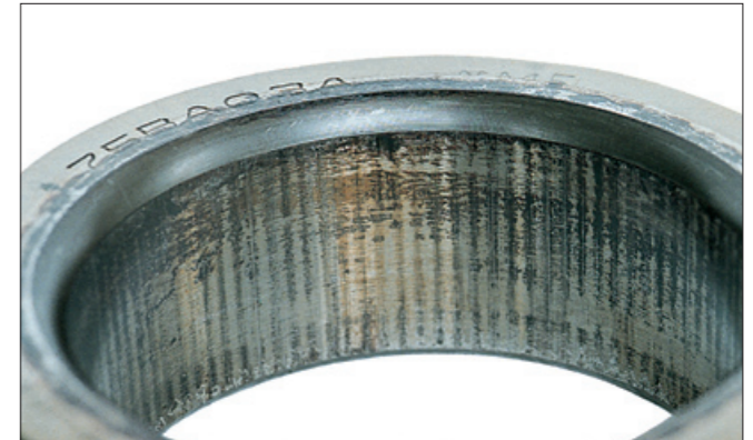
写真11-2 ●アンギュラ玉軸受の内輪。 ●内径面全周に生じた著しいフレッチング。 ●しめしろの不足によるもの。
