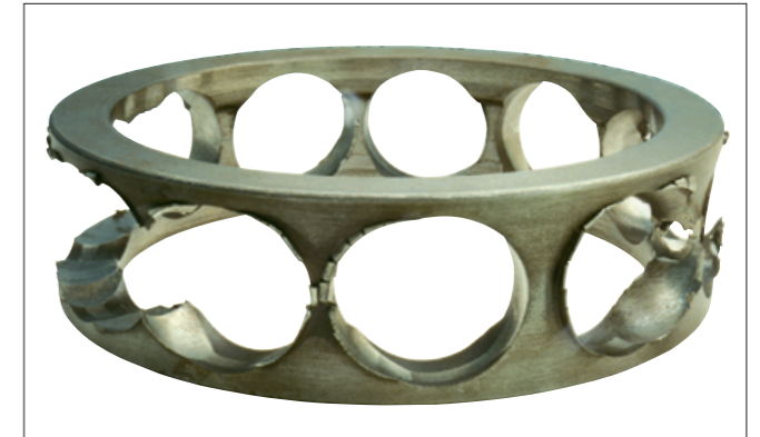
写真7-2 ●アンギュラ玉軸受の保持器。 ●鋳鉄もみ抜き保持器のポケット柱の折損。 ●内外輪の傾いた取付けによる保持器への異常荷重の作用が原因。
