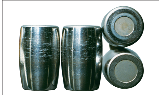
写真3-2 ●写真3-1の球面ころ。 ●ころ端面に生じたかじり。 ●急加減速によるころの滑りが原因。
