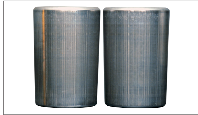
写真15-2 ●写真15-1の円すいころ軸受の内輪。 ●転動面に生じた縞模様の電食。
