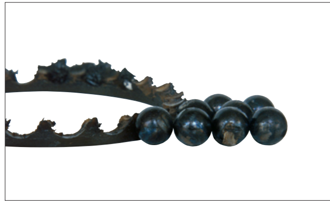
写真13-5 ●写真13-3の保持器・ボール。 ●保持器が熔融破損し、玉は変色、熔融している。 ●予圧過大によるもの。
