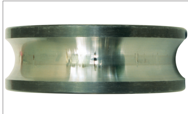
写真12-1 ●深溝玉軸受の内輪。 ●軌道輪に生じたフォールスブリネリング。 ●回転停止時の外部からの振動によるもの。
