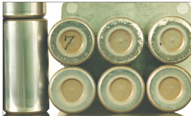
写真3-4 ●複列円筒ころ軸受のころ。 ●ころ端面に生じたかじり。 ●潤滑不良、過大アキシャル荷重によるもの。
