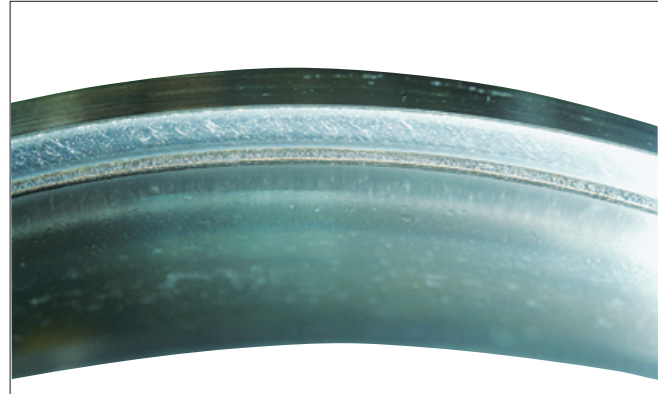
写真3-1 ●自動調心ころ軸受の内輪。 ●内輪大つば面に生じたかじり。 ●急加減速によるころの滑りが原因。
