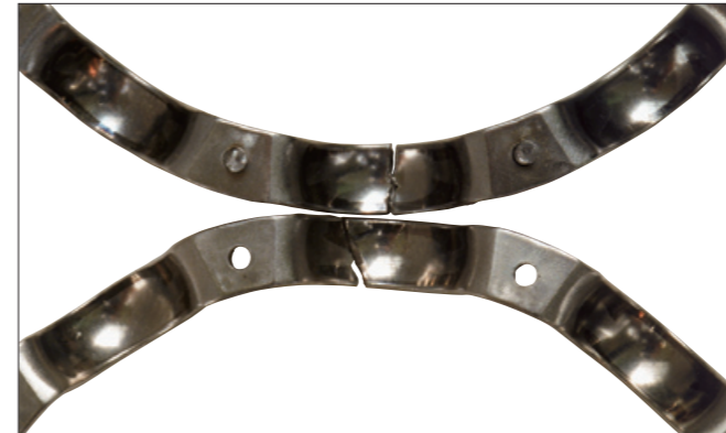
写真7-1 ●深溝玉軸受の保持器。 ●鋼板打抜き保持器のポケット部折損。
