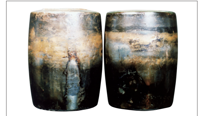
写真13-2 ●写真13-1の球面ころ。 ●ころ転動面が変色、溶融し保持器摩耗粉が付着している。 ●潤滑不足によるもの。
