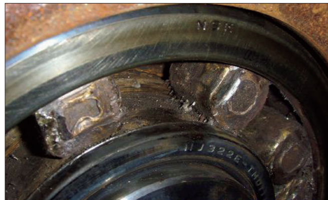
写真13-7 ●円筒ころ軸受。 ●リング軌道面ところの焼付き。 ●高速軽荷重の条件下で滑りによる内輪が高温となり、軸受内部すきま不足、発熱、最終的に焼付きに至った。
