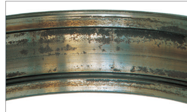
写真16-1 ●円筒ころ軸受の外輪。 ●軌道面及びつば面に生じたさび。 ●水分の浸入による潤滑不良が原因。
