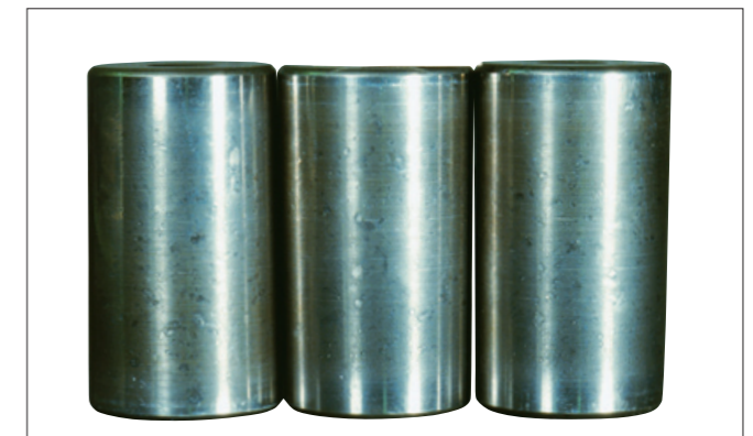
写真8-4 ●写真8-3の円すいころ。 ●転動面全周に生じた無数の大小圧こん。 ●異物のかみ込みによるもの。
