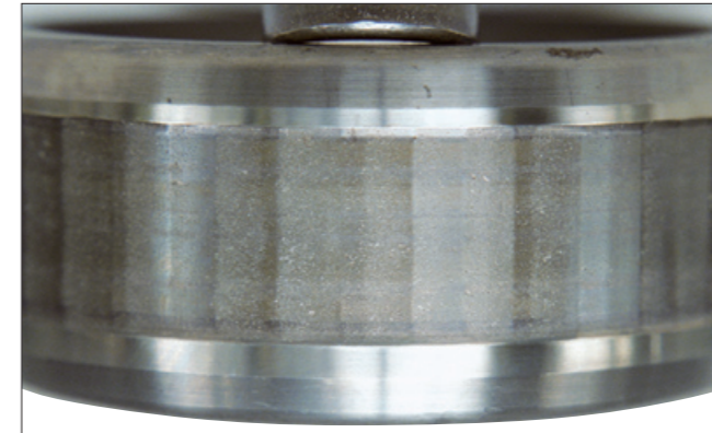
写真10-1 ●円筒ころ軸受の内輪。 ●軌道面に生じた波状摩耗と電食による多数のピット。 ●電食からの進展によるもの。
