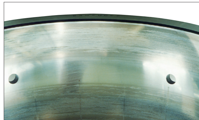
写真4-4 ●写真4-3の外輪。 ●軌道面の円周方向に生じたスミアリング。 ●潤滑不良によるもの。
