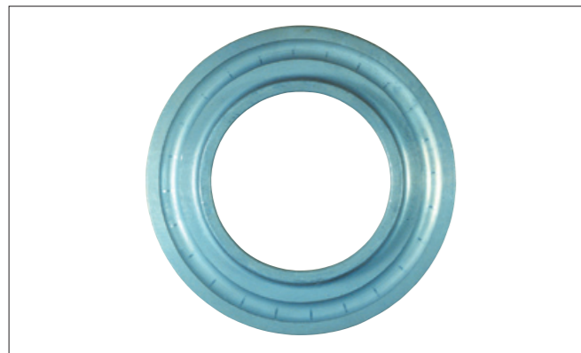
写真12-3 ●スラスト玉軸受の外輪。 ●軌道面に発生した玉ピッチのフォールスブリネリング。 ●小さい揺動角での繰返し揺動によるもの。
