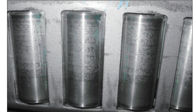
写真4-8 ●大形円すいころ軸受のころ。 ●ころ転動面に生じたスミアリング。 ●軽荷重及び潤滑不良によるもの。
