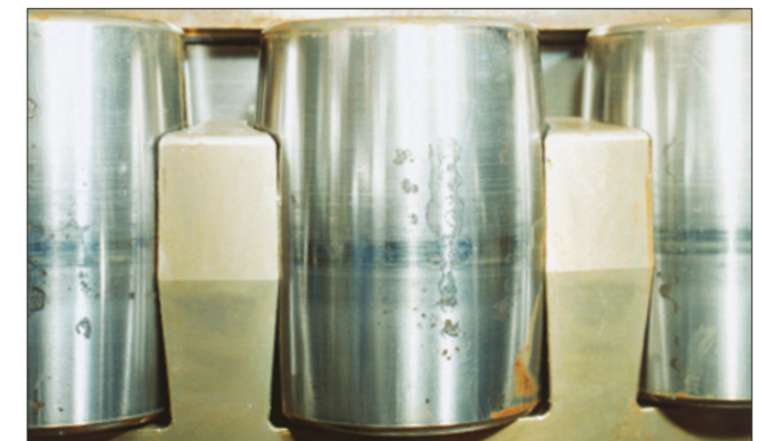
写真16-4 ●自動調心ころ軸受のころ。 ●転動面に発生したピット状さび。腐食している部分がある。 ●保管中の水分の凝結によるもの。
