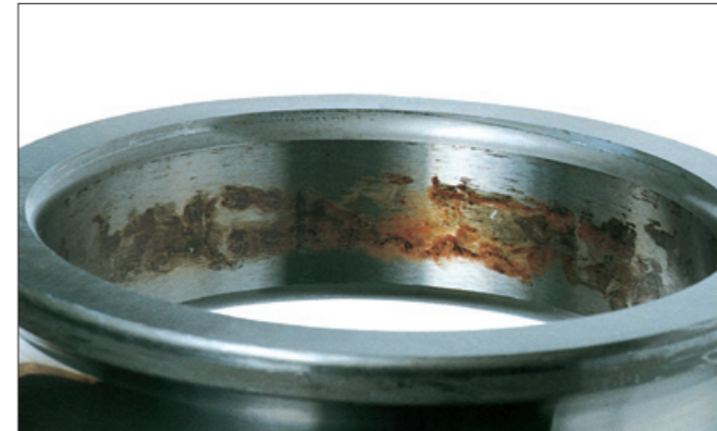
写真11-1 ●深溝玉軸受の内輪。 ●内径面に生じたフレッチング。 ●振動によるもの。
