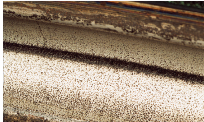
写真9-1 ●巡回輪軸受の外輪。 ●軌道面に生じたなし地状の面。くぼみの底は侵食している。
