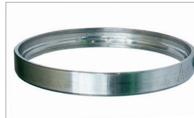
写真1-3 ●写真1-4の外輪。 ●軌道面に生じたボールピッチのフレーキング。 ●運転休止時の衝撃荷重による圧こんからの進展。
