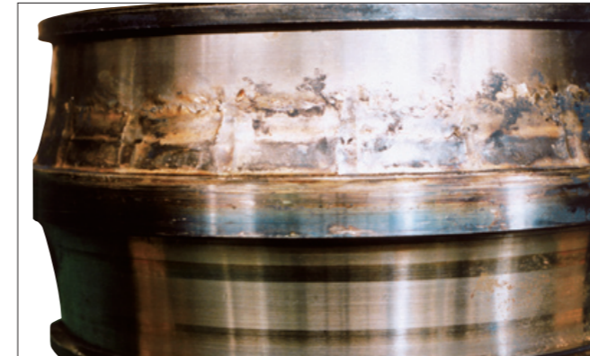
写真13-1 ●自動調心ころ軸受の内輪。 ●軌道面が変色、溶融し保持器摩耗粉が付着している。 ●潤滑不足によるもの。
