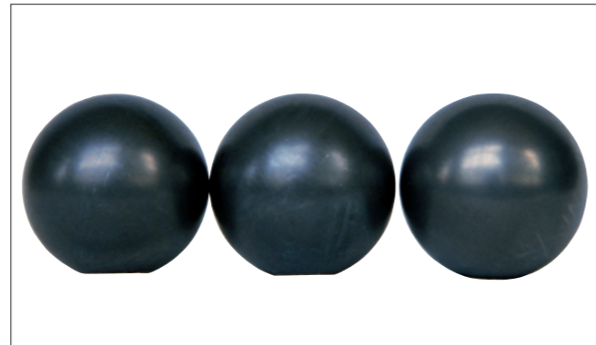
写真15-4 ●深溝玉軸受のボール。 ●転動面に生じた濃い着色(全面)が電食。
