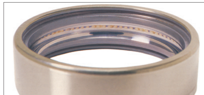
写真15-6 ●深溝玉軸受の外輪。 ●軌道面に生じた縞模様の電食。(高周波)
