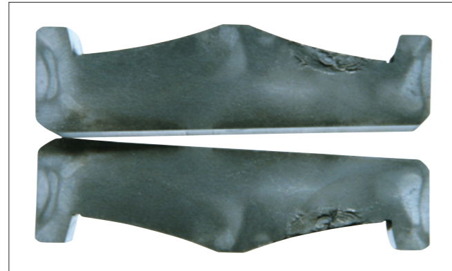
写真6-7 ●写真6-6の内輪の破断面。 ●軌道面直下に起点が認められる。
