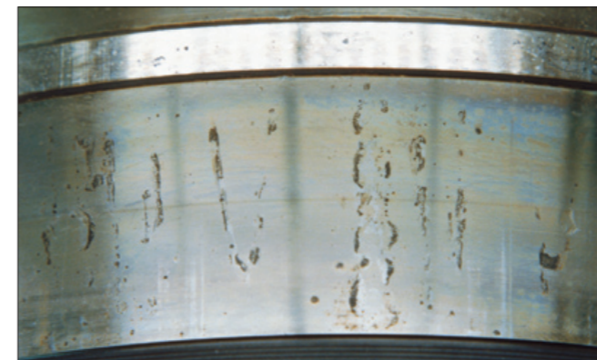
写真16-3 ●自動調心ころ軸受の内輪。 ●軌道面に生じたころピッチのさび。 ●潤滑剤中への水分などの浸入によるもの。
