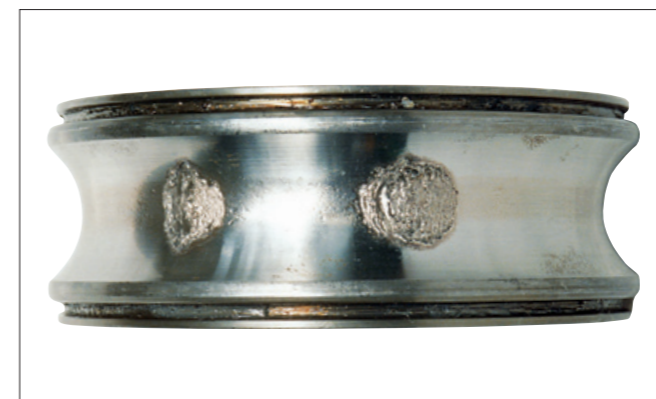
写真1-15 ●深溝玉軸受の内輪。 ●軌道面に生じたボールピッチのフレーキング。 ●取付け時の衝撃荷重による圧こんからの進展。
