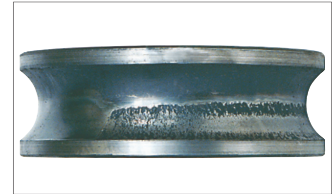
写真1-2 ●アンギュラ玉軸受の内輪。 ●軌道に対し斜めに生じたフレーキング。 ●取付け時の心出し不良によるもの。
