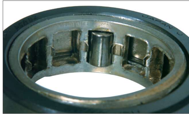
写真7-7 ●円筒ころ軸受の保持器。 ●高力黄銅鋳物もみ抜き保持器のポケットの摩耗と変形。
