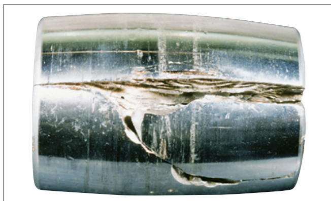
写真6-8 ●自動調心ころ軸受のころ。 ●転動面に生じた軸方向の割れ。
