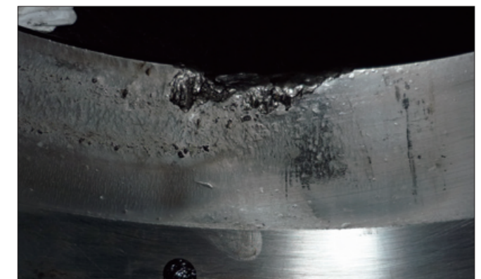
写真10-4 ●写真10-3の軌道面。（単列拡大） ●軌道面の摩耗や小さなく離の複合損傷。 ●潤滑不良による油膜切れ、摩耗損傷（1次損傷）→はく離（2次損傷）に至った。
