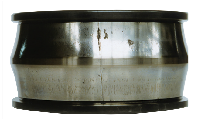
写真6-6 ●自動調心ころ軸受の内輪。 ●軌道面に生じた軸方向の割れ。 ●軸と内輪の温度差によるはめあい応力大が原因。
