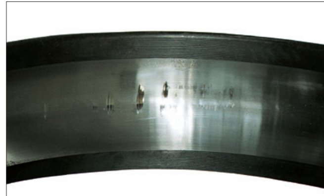
写真12-2 ●写真12-1の外輪。 ●軌道輪に生じたフォールスブリネリング。 ●回転停止時の外部からの振動によるもの。
