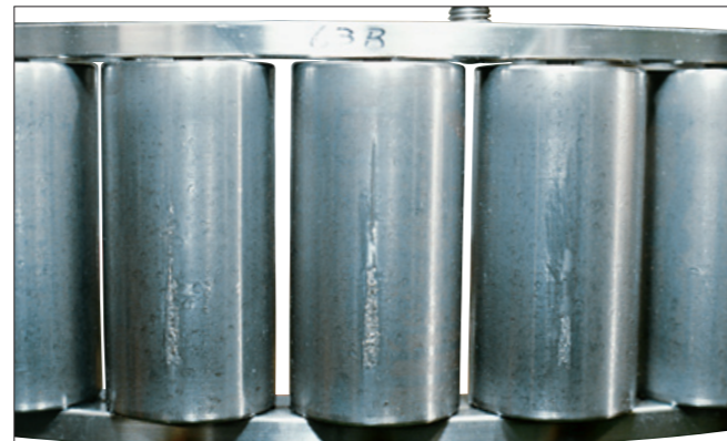
写真1-8 ●円筒ころ軸受のころ。 ●転動面の軸方向に生じた初期フレーキング。 ●取付不良による組込みきずからの進展。
