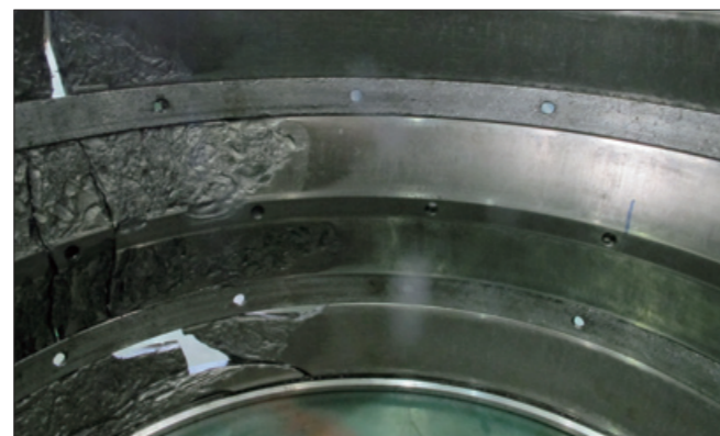
写真6-9 ●4列円すいころ軸受の外輪。 ●外輪軌道面に生じたフレーキング後の2次損傷。(欠け)
