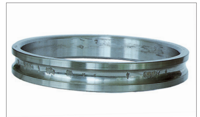
写真1-16 ●アンギュラ玉軸受の内輪。 ●軌道面に生じたボールピッチのフレーキング。 ●運転休止時の衝撃荷重による圧こんからの進展。
