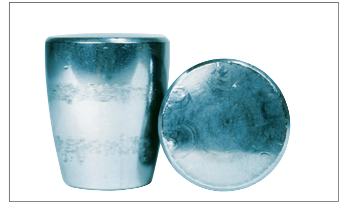
写真3-6 ●写真3-5の球面ころ。 ●ころ端面に生じたかじり。 ●異物のかみ込み、過大アキシャル荷重によるもの。
