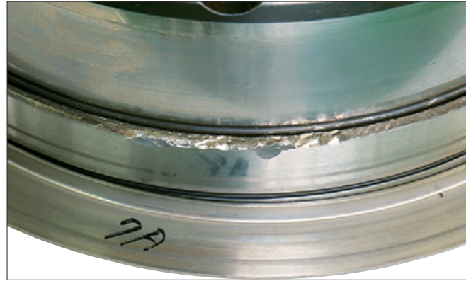
写真5-1 ●複列円筒ころ軸受の内輪。 ●中つば部に生じた欠け。 ●取付け時の過大荷重によるもの。
