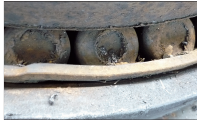
写真13-6 ●大形円すいころ軸受のころ。 ●ころ端面（頭部）に生じた焼付き。 ●潤滑不良及び過大アキシャル荷重によるもの。
