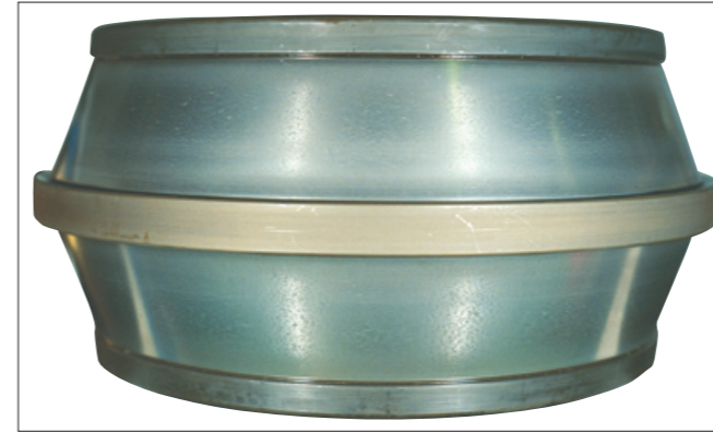
写真8-1 ●複列円すいころ軸受の内輪。 ●軌道面に生じた無数の微小圧こん。 ●異物のかみ込みによるもの。
