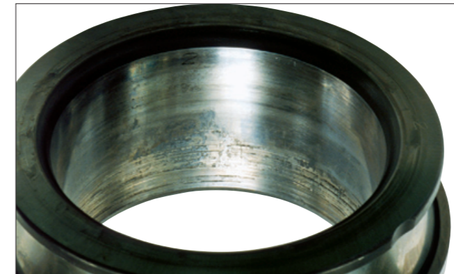
写真14-1 ●自動調心ころ軸受の内輪。 ●内径面に生じたかじりを伴ったクリープ。 ●しめしろ不足によるもの。
