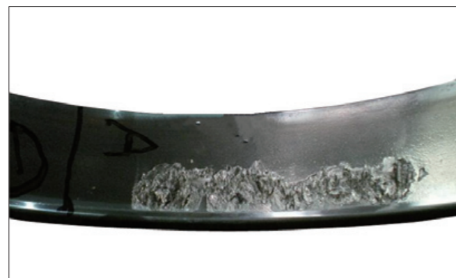
写真1-10 ●写真1-9の軌道面の拡大。 ●外輪軌道面の片側に生じたフレーキング。 ●ミスアライメントによる過大面圧が原因。
