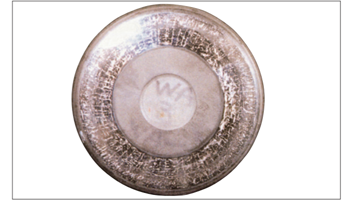
写真6-2 ●スラスト円すいころ軸受のころ。 ●ころ頭部端面に生じたサーマルクラック。 ●潤滑不良による内輪つばとの滑り発熱が原因。
