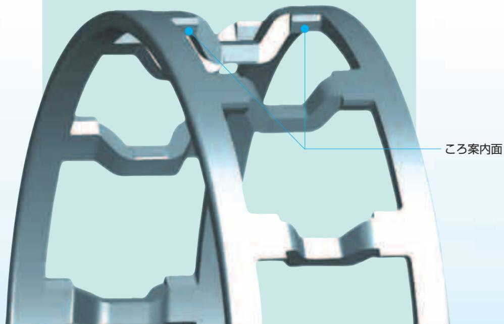
弊社では従来、小形単列円筒ころ軸受の標準保持器として、標準軸受として…………… W (鋼板打抜き形羽根付保持器) 高負荷容量Eタイプとして…………… ET (主にポリアミド成形保持器) を提供してきました。
