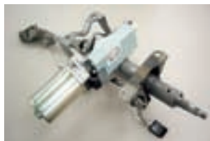
メカトロニクス機構とモータを一体化した軽量・コンパクトで高出力なコラムタイプEPS
