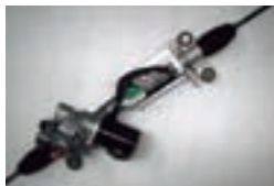
モータの小型化と低騒音を実現した高出力ピニオン式電動パワーステアリング
