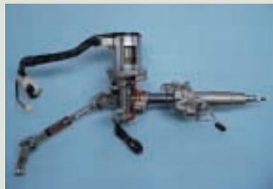
世界初！ハンドルの振動を抑える電動パワーステアリング
