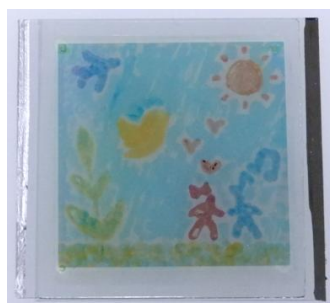
図 8 色素ペンで染色した酸化チタンで作製した色素増感太陽電池
