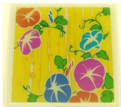
図 10 インクジェット印刷で描画して作製した色素増感太陽電池パネル
