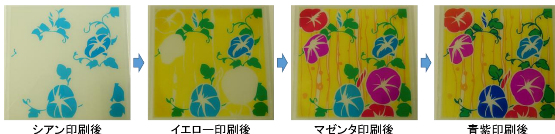
図 9 色素染色酸化チタン外観(導電膜付基板側より見た外観写真)
