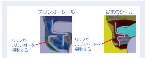
図 11 スリンガシールと従来型シール
