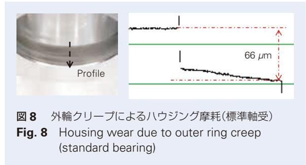
図8 外輪クリープによるハウジング摩耗(標準軸受)
