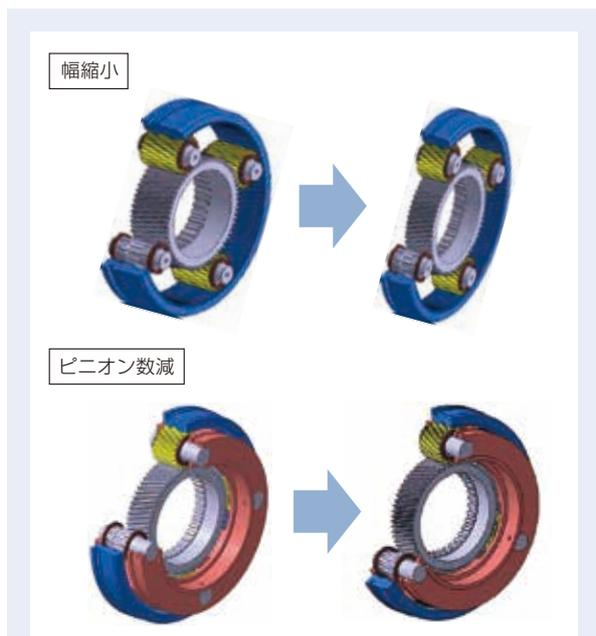
図2 遊星ギヤの小型軽量化の例
