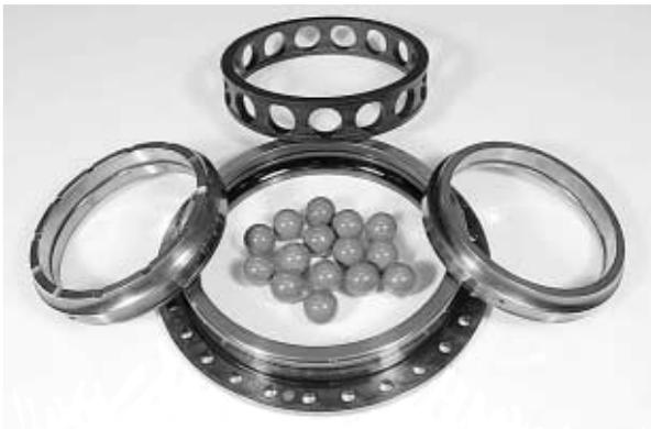
図15 試験後軸受外観 (Type D)
