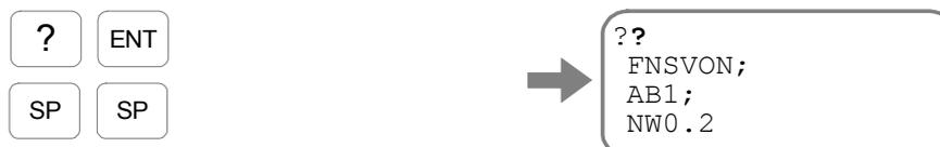
**SP** キーを入力する度に、パラメータ FN、パラメータ AB、パラメータ NW が表示されます。パラメータ AB が AB1 であることを確認してください。
