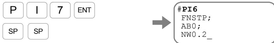
[SP] キーを入力する度に、パラメータ AB：接点、パラメータ NW：チャタリング防止タイマ が表示されます。
