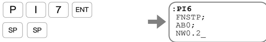
**SP** キーを入力する度に、パラメータ AB：接点、パラメータ NW：チャタリング防止 タイマ が表示されます。
