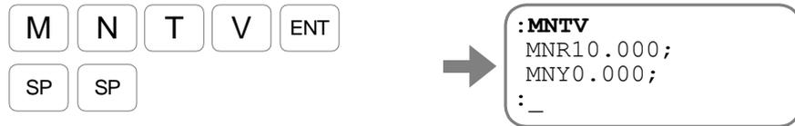
デフォルトとしてモニタのセンターが  $0 [s^{-1}]$  (MNY0.000) , 出力レンジが  $\pm 10 [s^{-1}]$  (MNR10.000) であることが表示されます。[SP] キーを入力し、プロンプト “: (コロン)” を表示させてください。
