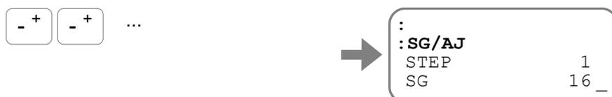
⑤ 発振の状態から抜け出した SG 値から 80%を計算します。
