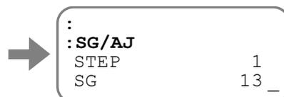
⑥ **ENT** キー入力で調整完了となり、変更されたパラメータを表示します。
