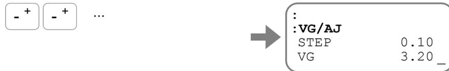
⑦ **[ENT]** キーを入力してください。プロンプトが表示され調整が完了します。
