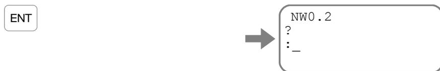
⑥コマンド SV：サーボオン許可 を入力し、モータをサーボオン許可状態に戻します。
