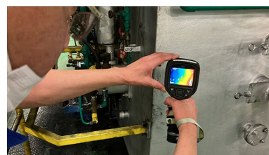
熱処理炉の表面温度を測定（榛名工場）
