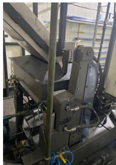
ピータリー工場に導入したブリケット化設備
