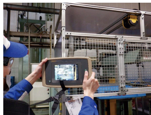
石部工場でのエア漏れ検出の様子
