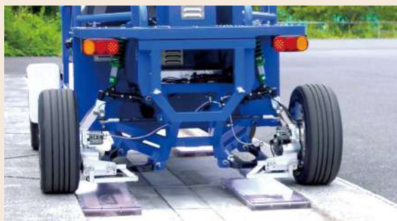
「第3世代」の走行中ワイヤレス給電インホイールモータ
