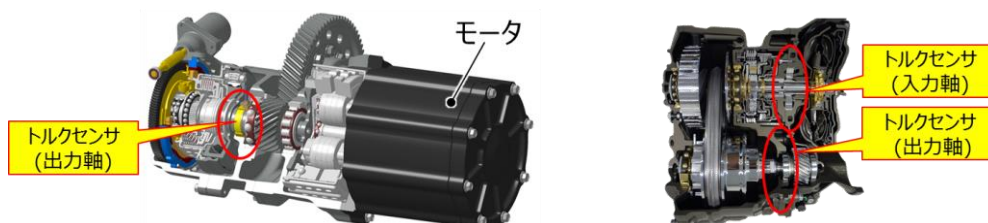
トルクセンサの搭載例(左:2速変速機の出力軸、右:ベルト式 CVT の入力・出力軸)
