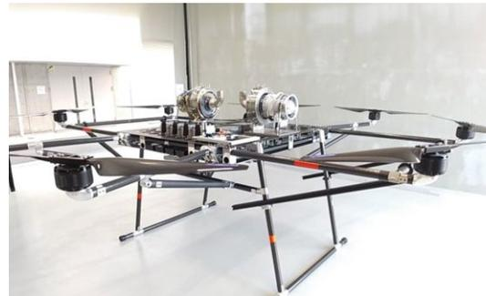
ガスタービン発電機を搭載した高ペイロード緊急物資輸送用ドローン
