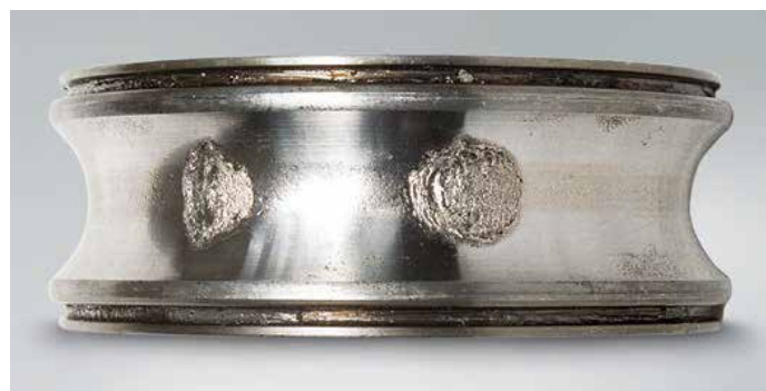
Typowe oznaki zmęczenia: oddzielanie się płaskich płatek materiału łożyska (złuszczenie)
