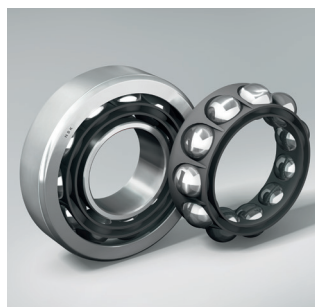
Roulements à une rangée de billes à contact oblique : montés par paires, le jeu entre les roulements doit être ajusté avec précision.
