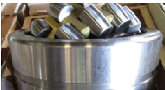
Est-ce de la contrefaçon ? Oui. Points à vérifier: un roulement authentique possède des trous de levage, n'a pas d'arrondis polis et les rouleaux présentent des indentations.
