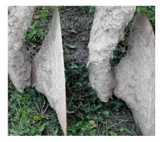
Typisches Bild einer Kurzscheibenegge mit starken Verschmutzungen nach Einsatz mit Gülle.
