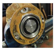
Das Bild zeigt, dass weder Verschmutzungen noch Rost im relevanten Bereich unterhalb des O-Rings zu finden sind.
