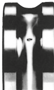
Fig. 5.1 Escamamento na Pista
