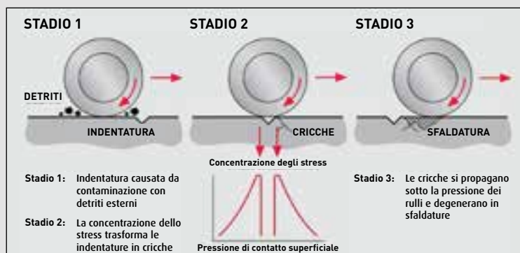
Sfaldatura superficiale in ambienti contaminati
